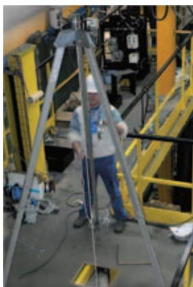
Il dispositivo è da utilizzare esclusivamente con la relativa fune semistatica per Derope™ Tractel® con diametro 10,5 mm e lunghezza variabile: da 20 a 100 m, che viene fornita già inserita nel dispositivo da personale Tractel®
