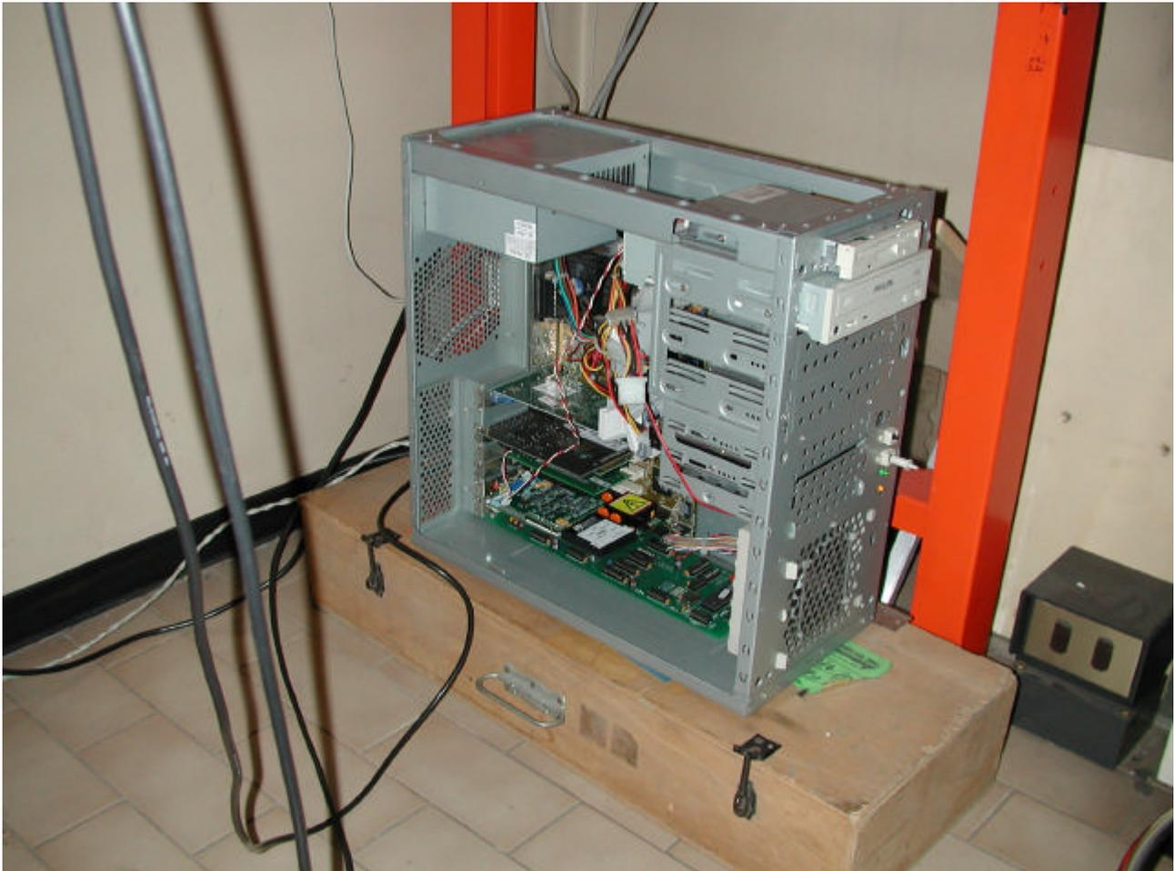
**Figura 11.** *La scheda che contiene l'elettronica per effettuare la integrazione, la sincronizzazione e la conversione del segnale e' quella sulla sinistra in basso.*
