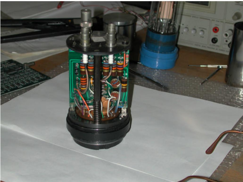
**Figura 8.** Partitore di tensione: distribuisce la tensione ai dinodi.
