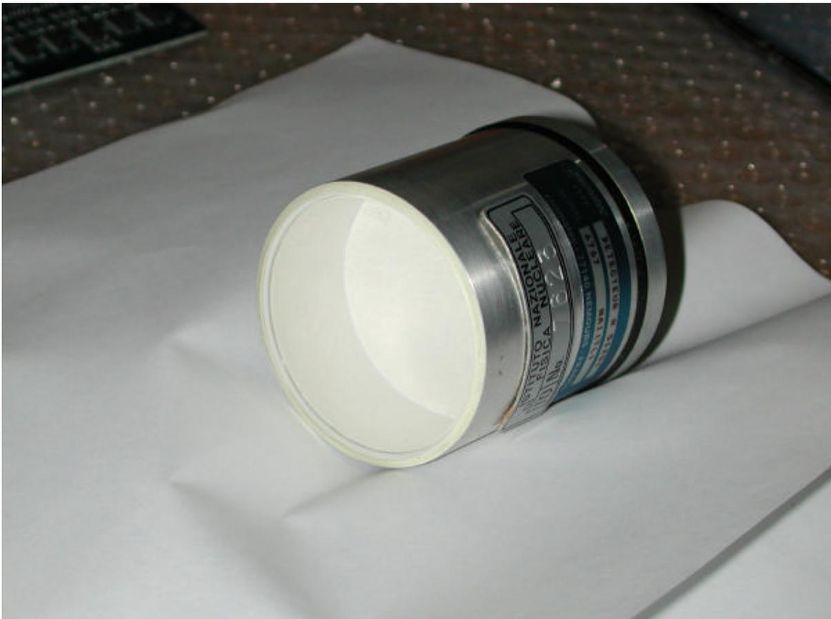
**Figura 6.** Esempio di rivelatore di NaI: l'involucro è completamente di alluminio, eccetto che per una delle due basi che è costituita da una finestra di vetro. L'involucro deve essere a tenuta in quanto lo NaI è igroscopico e in presenza di umidità perderebbe la trasparenza.
