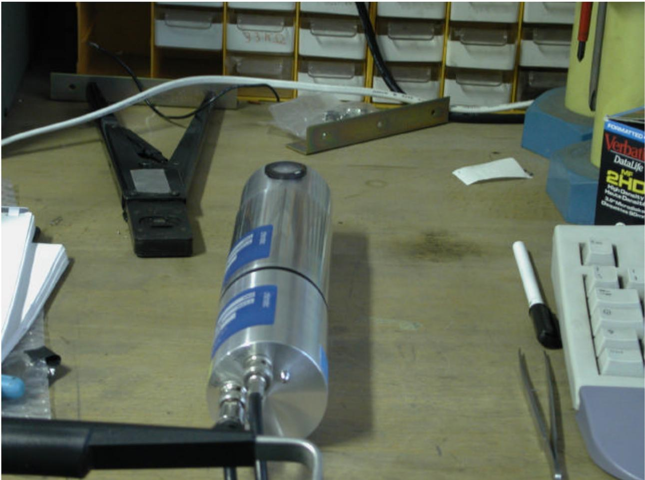
**Figura 16.** *Complessivo rivelatore costituito da fototubo e rivelatore NaI accoppiato. I due cavi che si intravedono (basso della foto) servono rispettivamente per portare la tensione (comunemente detta Alta Tensione poiche' si arriva a ~2000 Volt) e per prelevare il segnale.*
