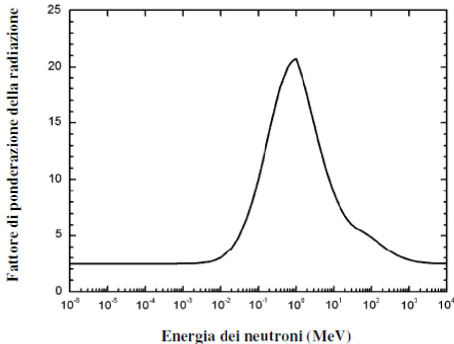
Figura n.1 - Fattore di ponderazione della radiazione,  $w_R$ , per i neutroni in funzione della loro energia
