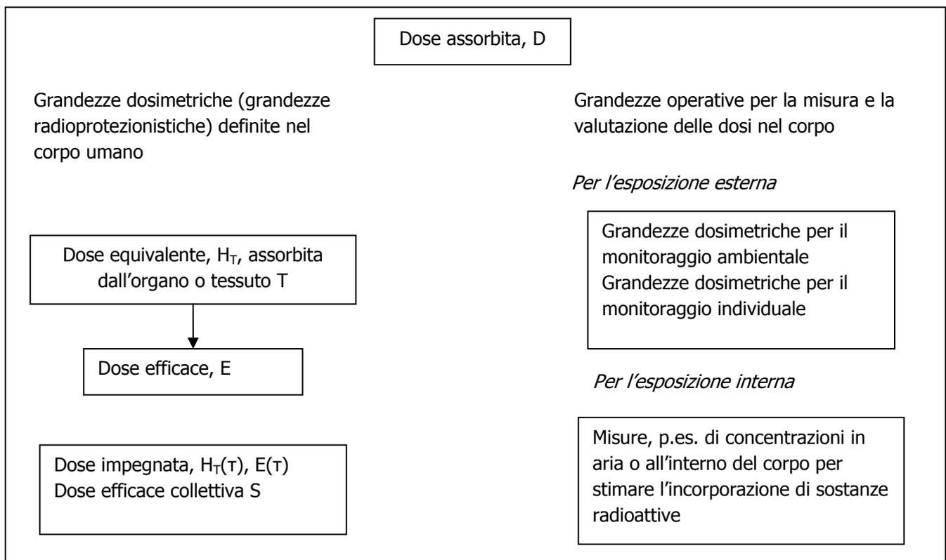
**Figura n. 2 - Il sistema di protezione radiologica e le grandezze operative in radioprotezione**
