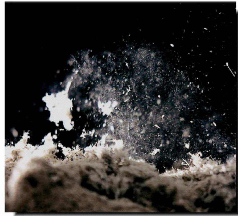
Friabilità e rilascio fibre
